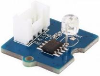
A small blue PCB sensor module with a white plastic housing and a clear lens, used for light detection.                 | <p data-bbox="810 248 1458 383">Ce capteur de lumière utilise la photorésistance GL5528 pour détecter la présence de lumière. La résistance du capteur diminue au fur et à mesure que l'intensité lumineuse augmente.</p>                            |
