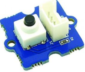
A blue PCB sensor module with a white plastic housing and a black push button, used for digital input.     | <p data-bbox="810 978 1501 1077">Ce module bouton-poussoir fait passer une sortie de l'état bas à l'état haut lors d'une pression. Il peut servir d'entrée digitale. Connecteur sur le dessus.</p>                                                   |
