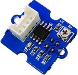
A blue PCB sensor module with a white plastic housing and a clear lens, used for infrared distance detection. | <p data-bbox="810 1386 1497 1520">Ce module infrarouge utilise un capteur RFR359F pour détecter une distance prédéfinie et changer d'état. Le réglage de la distance de référence se fait via un potentiomètre (portée 15 mm).</p>                   |
