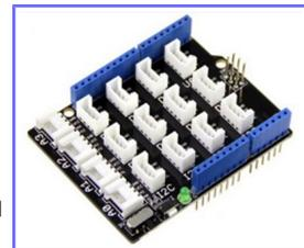
Le système "Grove" est spécialement conçu pour faciliter le prototypage rapide (sans soudure) d'applications diverses à partir d'une multitude de petits modules périphériques (capteurs, relais, interrupteurs, Leds, afficheurs, buzzer, lecteur RFID, modules de communication radio, etc...).
